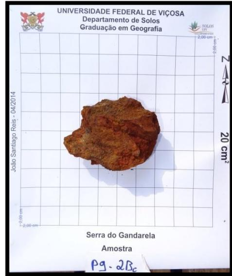
**FOTO 37.** Bloco de hematita primária em grau de degradação avançado encontrado em P9 – 2Bwc.
