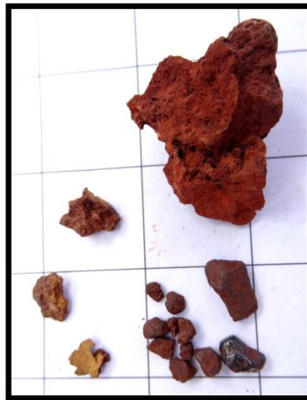
FOTO 33. Detalhe dos diferentes estágios de degradação da fração cascalho.
