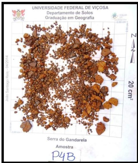
**FOTO 13.** Fração cascalho de P4 – Bwc. Concreções e hematita primária.
