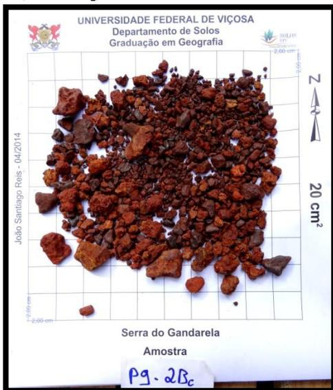
FOTO 34. Diversos tipos de seixos angulosos (concreções, nódulos e hematita primária) em P9 – 2Bwc.
