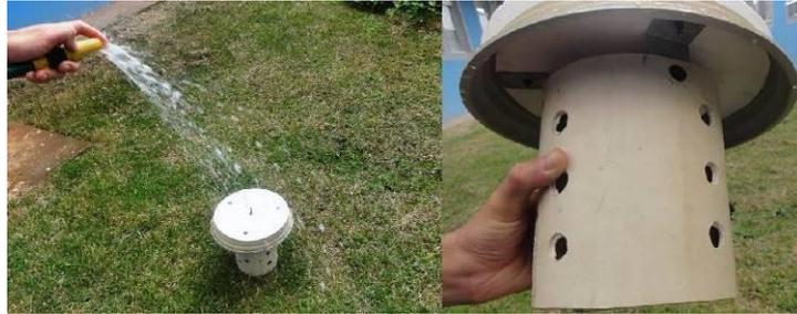
Figura 9. Teste de impermeabilidade do abrigo meteorológico alternativo.
