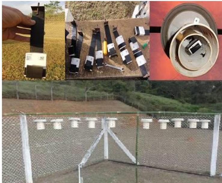
Figura 10. Miniabrigos meteorológicos alternativos fixados na Estação Meteorológica de Viçosa-MG a 1,5 metros de altura.
