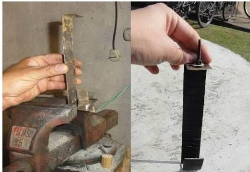
Figura 6: Elaboração da chapa de sustentação do datalogger.
