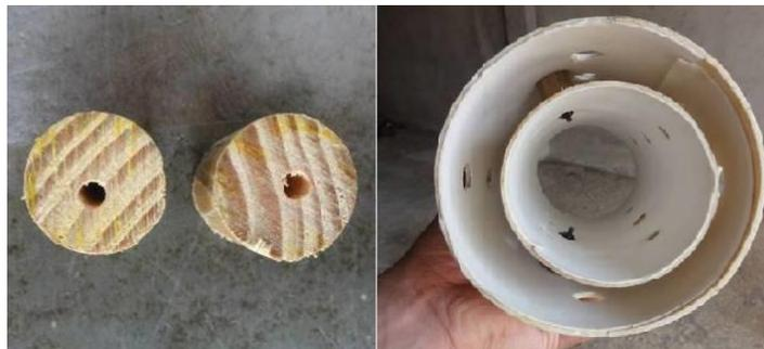
Figura 4: Fixação dos canos de PVC interno e externo utilizando 2 tocos de madeira.
