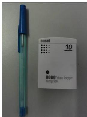
Figura 8. Termohigrômetro datalogger da marca Hobo, modelo U10-003.
