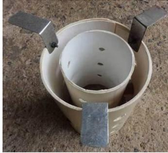
Figura 5: Chapas de estanho fixadas no abrigo meteorológico com a função de sustentar o prato de vaso de flor. Foto: Rafael de Souza Alves.
